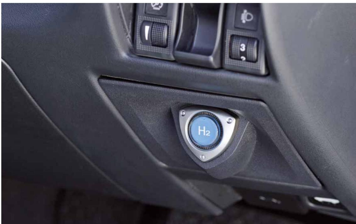
Il passaggio dal gas di idrogeno a benzina può essere effettuato utilizzando l'interruttore posto accanto al sedile di guida. Per passare dalla benzina all'idrogeno è necessario che il veicolo sia fermo. Inoltre, quando il serbatoio dell'idrogeno è vuoto, RX-8 Hydrogen RE passa automaticamente all'alimentazione a benzina.
